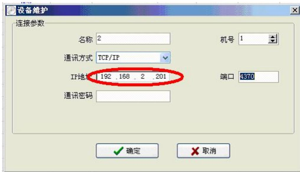
3. 3. 打开 HMman 管理软件，将 IP 地址设为考勤机的 IP 地址。测试连接。如果连接不成功，请检查网络是否联通，防火墙设置等。确认能连接考勤机后，可勾选自动连接，以便在下次启动本程序时自动连接。
